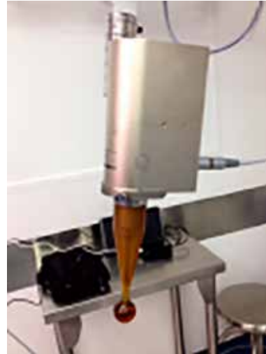
Figura 4. Generador de Rayos X con aplicador de 3,5 mm de diámetro.
